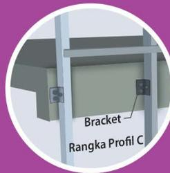
1. Pemasangan **RB Clad** dapat menggunakan rangka baja dengan braket, yang sesuai dengan jarak antar rangka *vertical* max 600 mm
