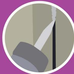
4. Gunakan *flexible sealant* yang memiliki ketahanan cuaca untuk mengisi celah sambungan.
